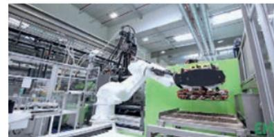
Préchauffage de la planche composites et mise en place de la nouvelle préforme.
